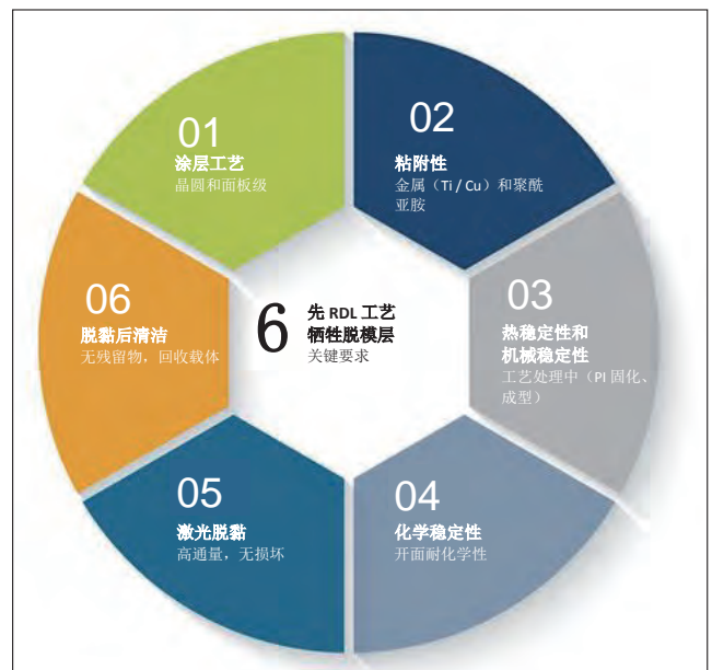
图 3. 先 RDL 工艺牺牲脱模层的关键要求。
