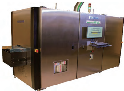
图3. 具有EA活化氢技术的大规模晶圆凸点回流炉。
