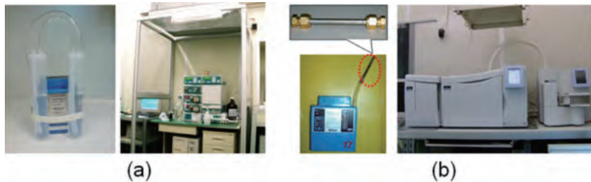
图2. 采样方法：(a)无机物使用；(b)有机物使用。
