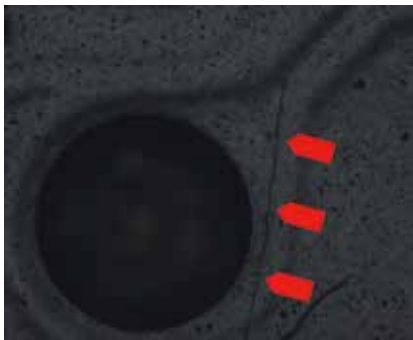
图 16. 在 TC500x -65°C / +150°C 之后 FBGA 上的阻焊层裂缝。
