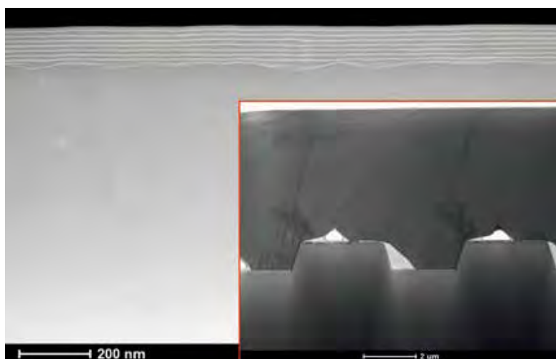
半极性(20 \bar{2} 1)InGaN / GaN多量子阱样品的透射电子显微镜 (TEM) 横截面图像。插图是半极性(20 \bar{2} 1)GaN模板的TEM横截面图像。
