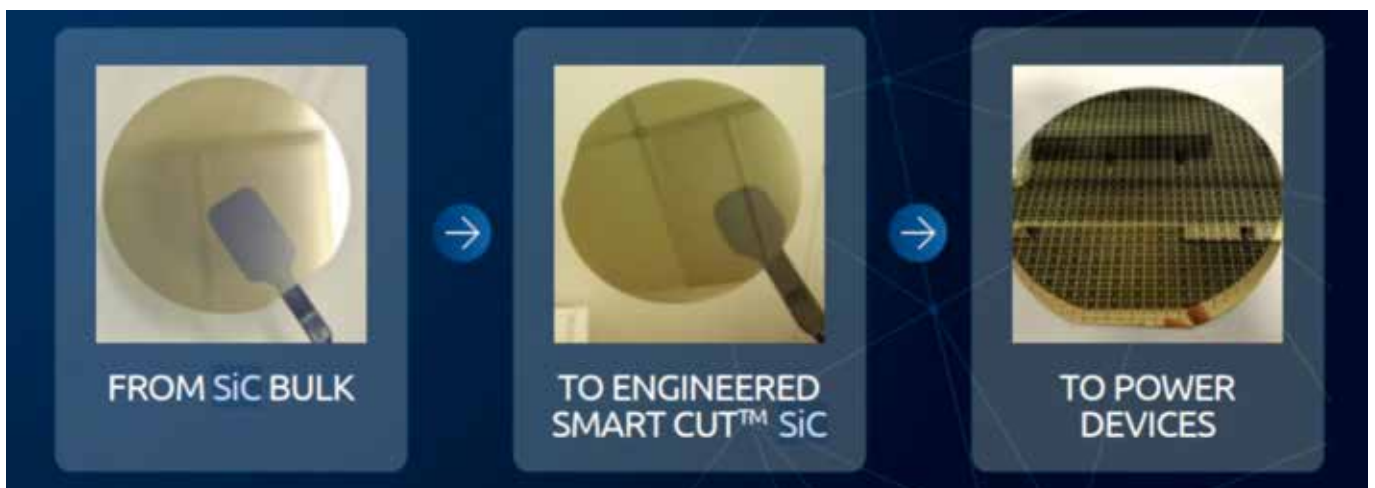
图3: 体 SiC (左)、Smart Cut SiC (中) 和带器件的 Smart Cut SiC (右) 的图片。
