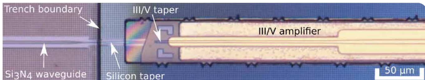
图2. 两级锥形联轴器结构上的微转移印刷试样的显微镜图像。
