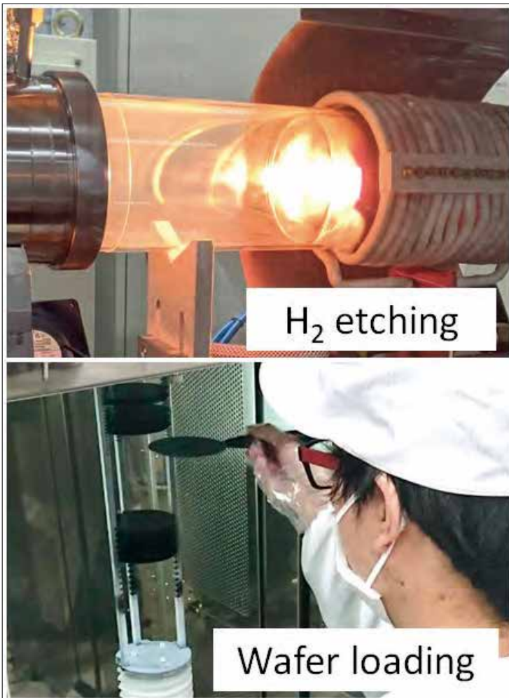
图 6. 用于界面氮化以形成高质量 SiO 2 /SiC 结构的高温氢蚀刻和晶圆加载。
