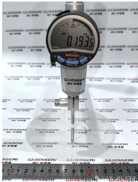
超薄6英寸氧化镓单晶衬底
