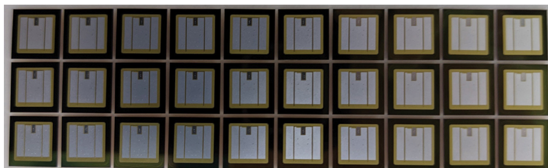
图4: 准备进行封装的 10kV 裸芯片。
