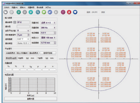
图8: SI-GaAs单晶片电阻率、迁移率、载流子浓度分布图。
