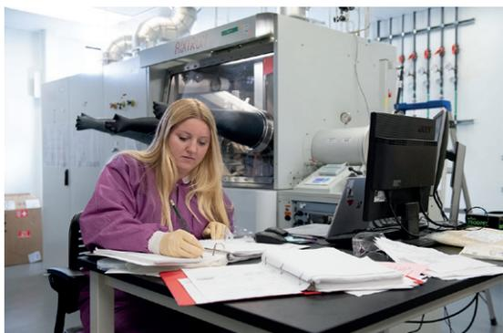
Savannah Eisner在斯坦福大学纳米制造厂的Aixtron MOCVD III-N系统旁，该系统正在生长氮化镓异质结构外延薄膜。
