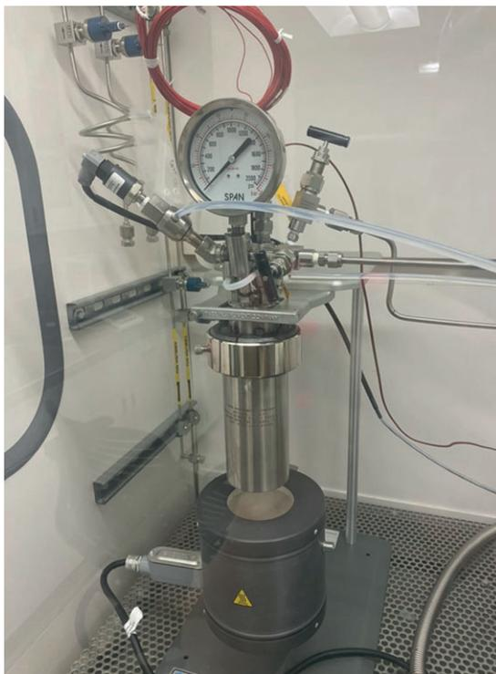
斯坦福大学极端环境微系统实验室 (XLab) 中的定制金星模拟舱，用于将器件置于真实的恶劣环境条件下。
