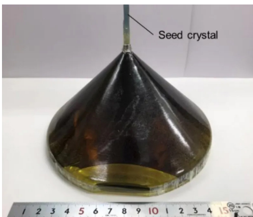
垂直布里奇曼法为尺寸更大的高品质晶圆铺平道路
