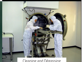
Cleaning and Dégassing
