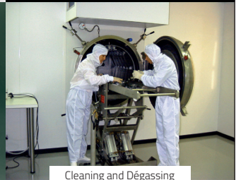
Cleaning and Dégassing
