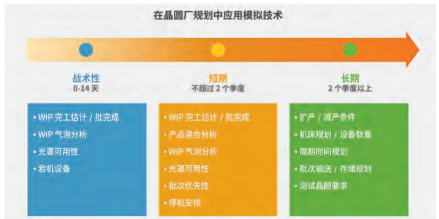
图3. 配备EngineeredWorks的SmartFactory解决方案可自动生成工厂活动的模拟和模型。本图给出了一些可能的建模场景示例。
