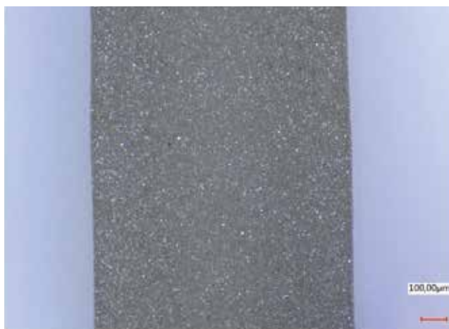
图4. Panacol用于5G EMI屏蔽的导电胶EI X-1310639 (-1)的喷胶效果。
