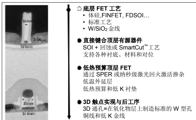
图9. 3D VLSI CoolCube™集成方案的工作原理。
