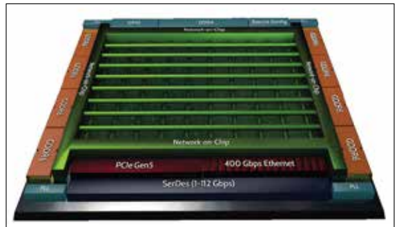
图1. Speedster 7t FPGA结构图。
