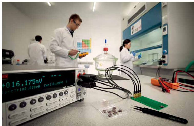
Paragraf 的科学家在对封装器件进行电气测量
