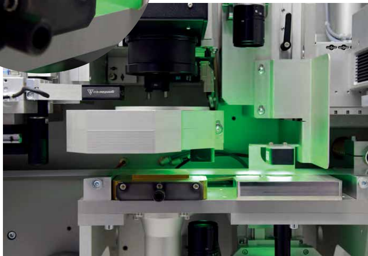
左：microFLEX 卷对卷激光微细加工系统实现以高达 50m/min 的加工速度连续高速加工。
