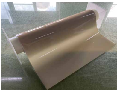
图1：积层胶膜实物图（图片来源：生益科技）
