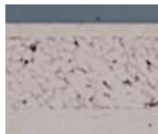
图2：互连后的金属纳米线界面
