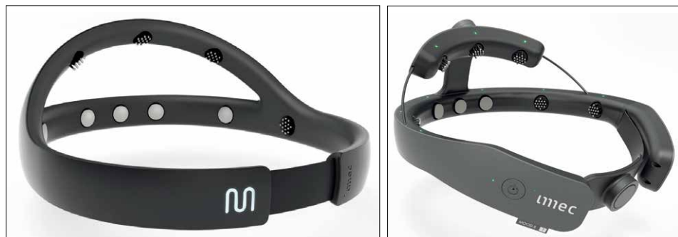
imec 的两款 EEG 头戴式设备：一款取自 2018 年发布的新闻稿，一款是为 Amorepacific 开发的一种用于香味研究的调研性设备。
