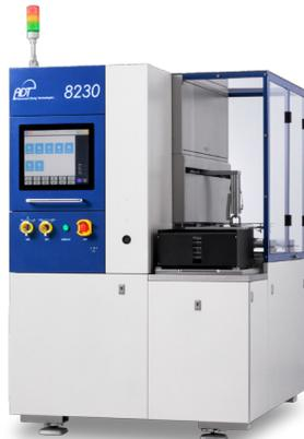
ADT 8230是一款高效率、高精度、高性能、低使用成本的双轴(对向)全自动划片机。最大切割工件尺寸可达12英寸。所配备的空气主轴转速可达60,000rpm/1.8KW(可选配2.2KW)，更换刀片时可锁定主轴，操作更快速、便捷。系统实现了产品搬送、拉直、切割、清洗等过程的全自动化。可基于自动刀痕检查功能进行自我调整，优化切割品质。设备运转过程中具有切割过程信息记录功能、耗材使用记录分析功能，设备生产数据记录分析功能和操作员生产数据记录分析功能，能够进行设备生产效率分析和人员绩效分析，大大提高了用户的生产管理效率和管理的精准度。
