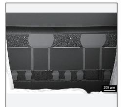
▲ 700 μm 宽的封装截面加工，包含 solder bump 和 TSV
