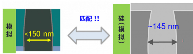
图5: 当弯曲关键尺寸小于150nm时, SEMulator3D预测的结果与实际的硅结果。
