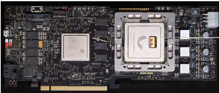
Hummingbird可集成在标准PCIe板上，具有良好的通用性
