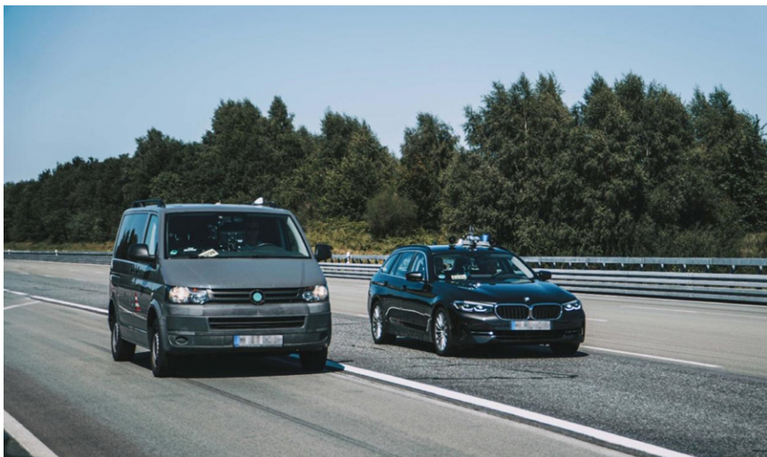
人类能否可靠地听到并检测到接近的紧急车辆的方向？Fraunhofer IDMT 的听力汽车采用外部声学感知技术来检测警报器发出的方向。© Fraunhofer IDMT / Anika Bödecker.
