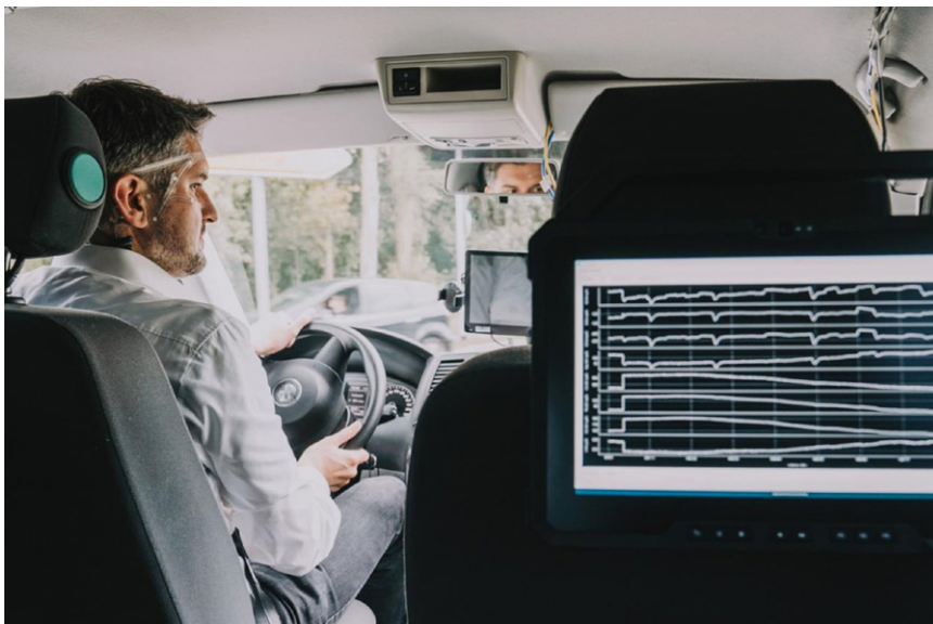
通过移动脑电图测量，研究人员可以检测注意力发生变化：神经元大脑活动。脑电图数据不仅可以在实验室中记录，还可以在现实驾驶情况下记录。© Fraunhofer IDMT /Leona Hofmann
