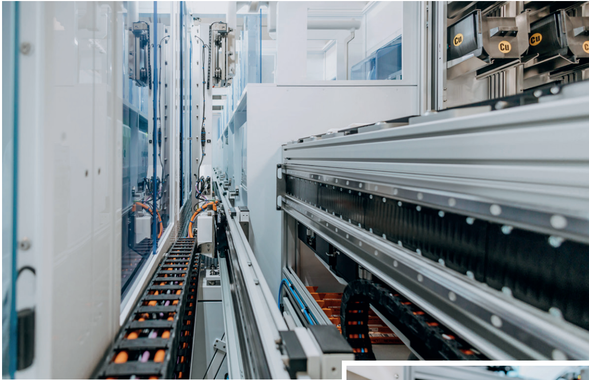
高度动态的轴系统，晶片传输和快速空运行
