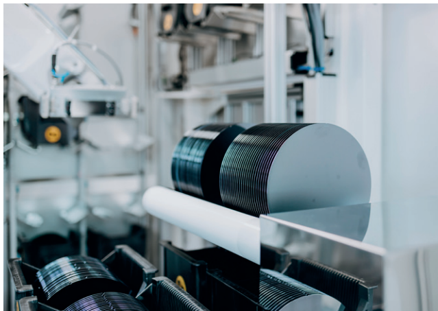
多达 12 个 LMC 晶圆载具，每个载具可容纳 2×100 片晶圆（8 英寸），可以实现高效加工处理
