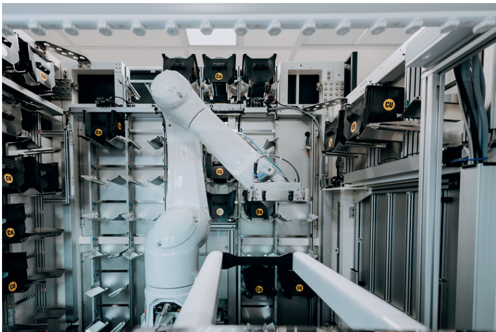
多达 75 个储存位置保证了生产流程的连续性
