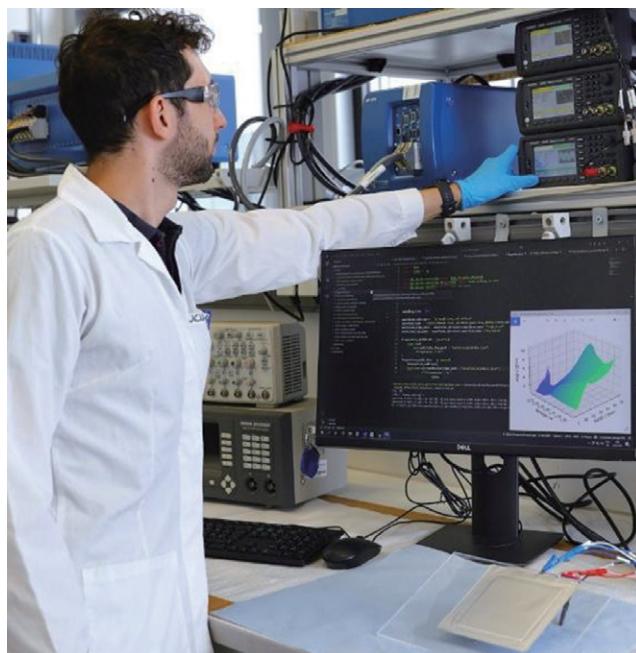
图1. 实验室中的计算机辅助实时电池测量装置，测量锂离子电池单体阻抗以分析其状态的。（图片来源：Fraunhofer IFAM）
