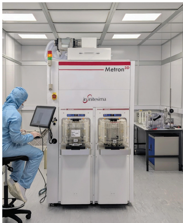
Infinitesima 公司的 Metron3D 量测系统专为高速测量半导体中具有挑战性的纳米级结构而设计。
