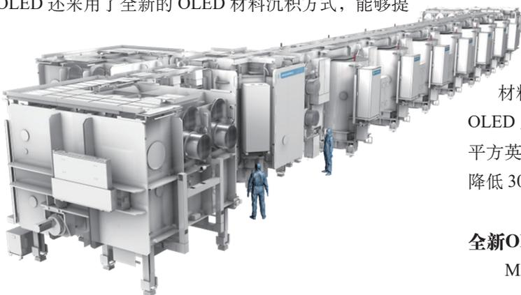
的制造工艺构建出专有像素结构，从而造就出色的 OLED 像素和显示屏。这一制造体系将多个关键制造模块整合到单一高真空系统中，以保护精细的 OLED 材料免受环境侵袭，并减少影响良率的颗粒物。MAX OLED 系统集成显示了玻璃搬运、多个 OLED 沉积步骤以及 OLED 封装。应用材料公司已经在大面积 LCD 屏幕的制造中验证了 MAX OLED 使用的多种核心技术，这些 LCD 屏幕的
