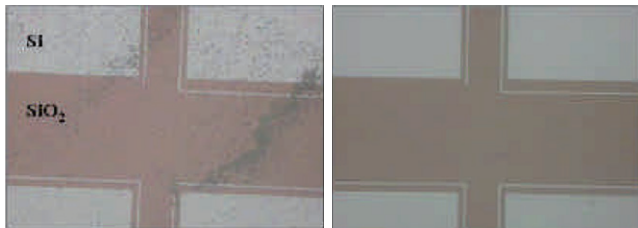
图3：硅/二氧化硅表面颗粒物清洗（左，清洗前；右，清洗后）
