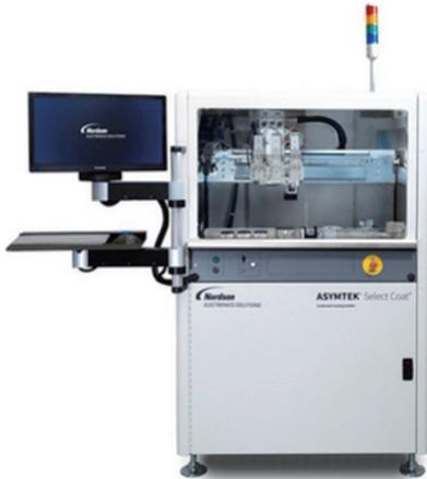
喷区域的良好控制力，同时能为工业 4.0 提供一致的设置、实现闭环反馈、可追溯性和数据记录。非常适合涂覆单个零部件和整个电路板。SL-1040 集成双涂覆头和三涂覆头可最大限度地提高产量，同时能通过高效转换、可追溯性和设置一致性这些灵活特性来进一步提升产量。
