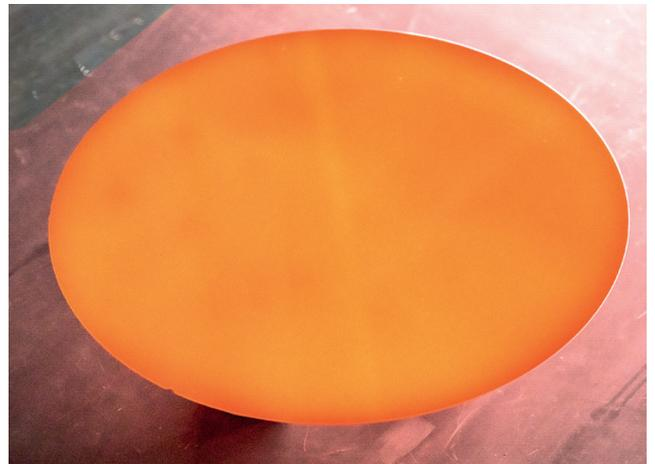
图2：200 mm硅晶圆通过激光加热到800° C的可见光图像。
