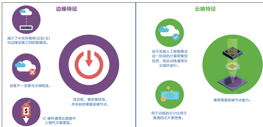
图2: 边缘处的人工智能与云端中的人工智能之间的不同特征。边缘计算环境是在某台设备上执行计算的环境（通常是创建数据的同一设备），该设备位于网络的边缘（因此，靠近用户）。这与位于网络中心的云计算或数据中心计算形成鲜明对比。来源：IDTechEx。
