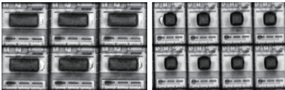
图9：HT-tech 氮化镓封装可靠性例行监控扫描图。
