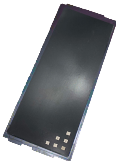
图 5: 层压覆到扁平 JEDEC 托盘上的微纹理薄膜的照片, 可以将不同尺寸的裸芯片粘附和固定。
