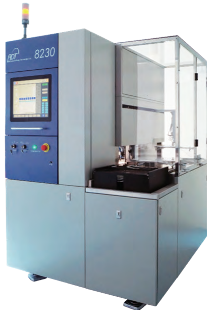
图1. 先进微电子的首台国产化设备，ADT 8230 系列12英寸全自动双轴划片机。
