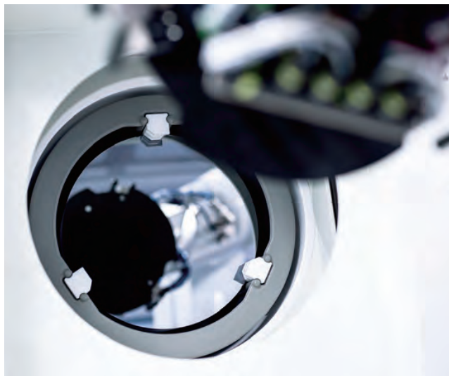
晶圆仅采用了3个RCH定位梳装置作为支撑点, 最终获得了超过80%的开口面积。
