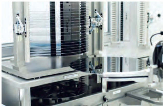
每批次晶圆装槽时, 首尾两端都插入屏蔽晶圆或挡片, 这对于工艺生产十分有益的。
