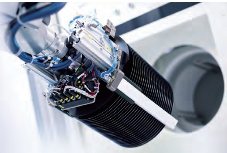
配件设计简单：在工艺腔室中部件不需要做机械运动或移动，可在没有教程指导的情况下轻易更换或维护。
