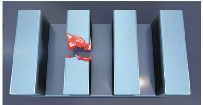
图2. 潜在缺陷的尺寸或位置特征 (左) 不会导致芯片故障。在车辆的极端运行环境如热、冷、振动、潮湿之中, 潜在的缺陷可能会被激活 (右), 从而导致芯片故障或发生操作失败。(图片来源: KLA Corporation)
