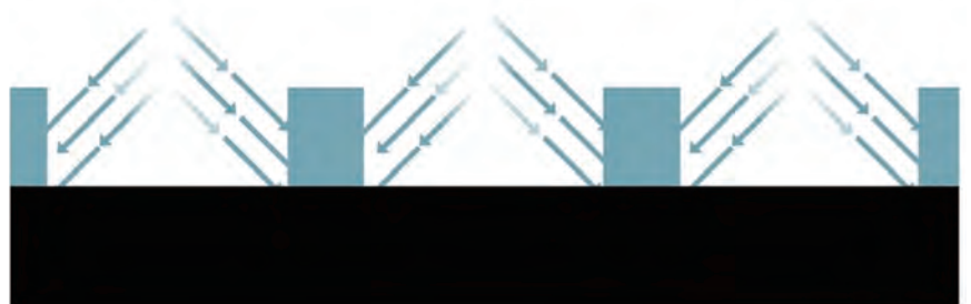
图4. 应用材料公司的创新型横向刻蚀技术可将EUV掩膜次数减少50%甚至更多。
