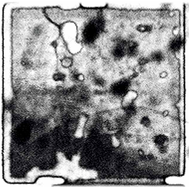
图1：通过穿透模块底部扫描制成的单色声学图像，显示出芯片键合粘附中的缺陷。
