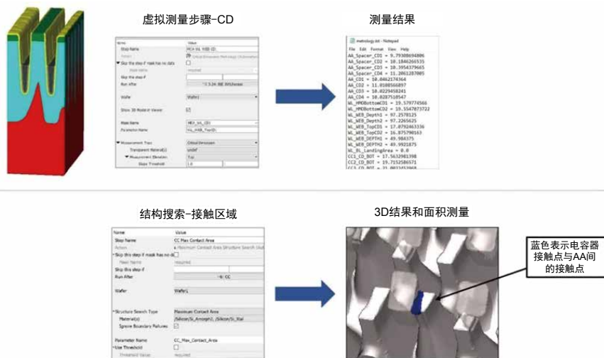
图5. 虚拟测量步骤 (顶部) 可帮助测量结构，包括 CD、刻蚀深度和薄膜厚度。结构搜索步骤 (底部) 可确定测量极值，并计算电网组件的数量，如识别网络短路或开路。
