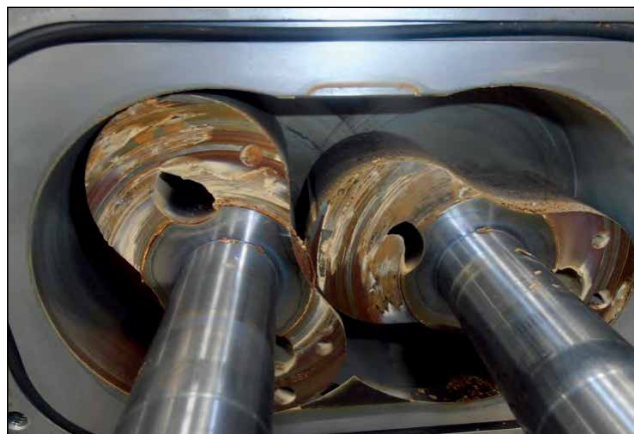
原子层沉积机台上的泵的振动信号（左）和附着有沉积物的内部组件照片（右）。数据分析预测了计划维护前机台故障的可能性。详细分析拆下的零件后，确认零件的确即将失效；主动更换零件可防止计划外的工艺停机和潜在的晶圆废料损失。
