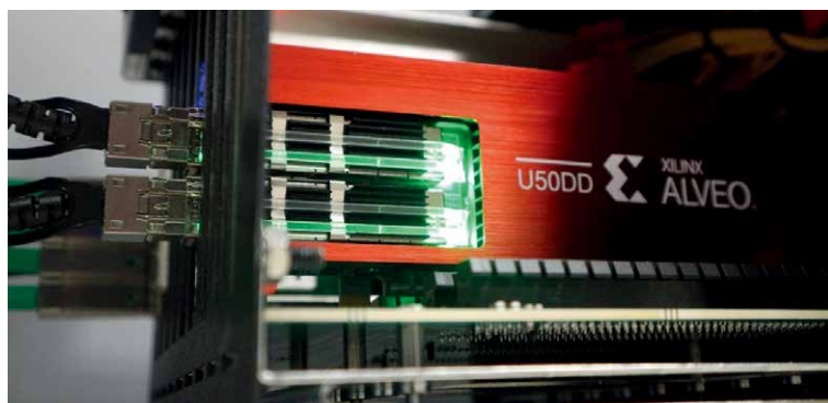
图 5: 专用 PCIe 扩展机箱中运行在 Alveo 上的 SMV 订阅加速器应用。
