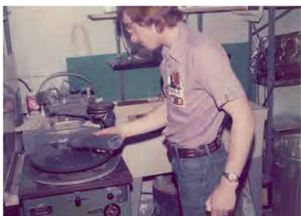
1972 年秋天，II-VI 投入大量精力学习如何切割、研磨和抛光碲化镉（左），对该材料进行光学测量（中），并应用光学薄膜涂层（右，图为联合创始人 Carl Johnson）。
