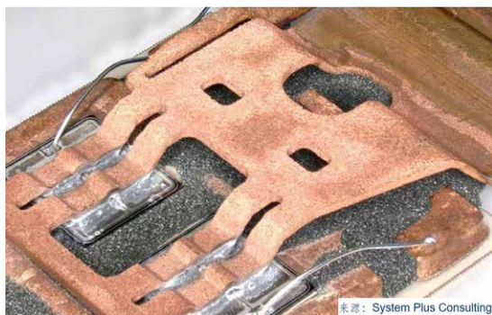
图5. 一种DTS实现，可见功率连接基于铜，但芯片表面仍为铝质，控制引线也为铝质。
