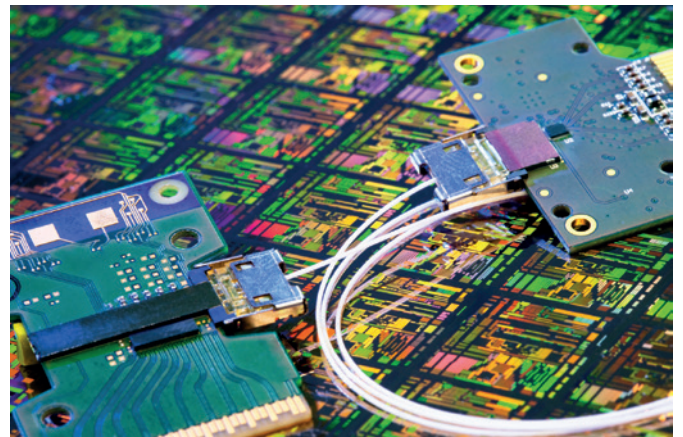
英特尔率先实现了磷化铟 (InP) 激光器与硅光子学的集成。在这个 50 Gbit/s 链路中，发射模块 (左侧) 将激光从绿色电路板中央的硅芯片发出，激光通过光纤传输到接收模块 (右侧)，在那里，第二个硅芯片检测激光上的数据，并将其转换为电信号。
