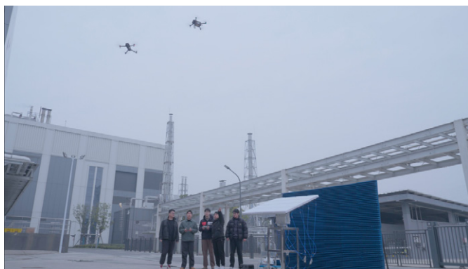
图2：氮化镓器件（九峰山实验室微波无线传能系统，在20米范围内实现对无人机的动态无线供能示范验证）
