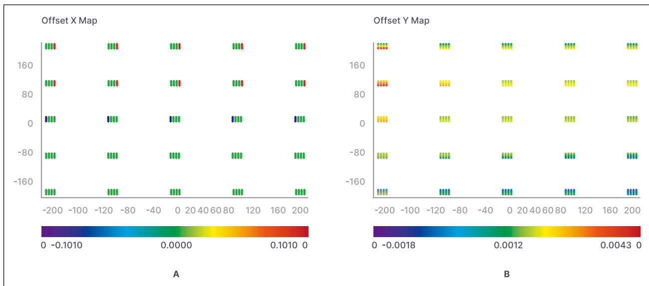
图5: (a) X 轴上芯片错误的热图。前两行 (红色) 中的右侧芯片具有+100 \mu m的错误。第三行 (蓝色) 的左侧芯片有-100 \mu m的错误, 反映了测试面板中故意设计的错误。(b) Y 轴上芯片错误的热图。所有的芯片错误都在-2 \mu m到4 \mu m之内。在芯片组内没有看到大的Y轴错误。
