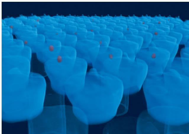
图1：市售CPU内C4凸块（直径：65 $\mu\text{m}$ ）的特写效果图。图片归Comet Yxlon公司所有，不得复制或分发传播。
