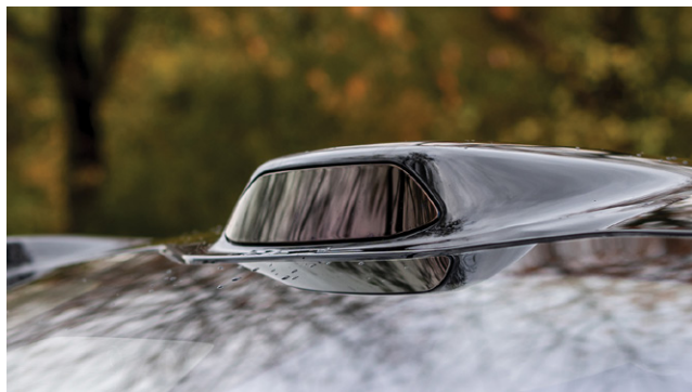
图 2：安装在车辆顶部的激光雷达模块
