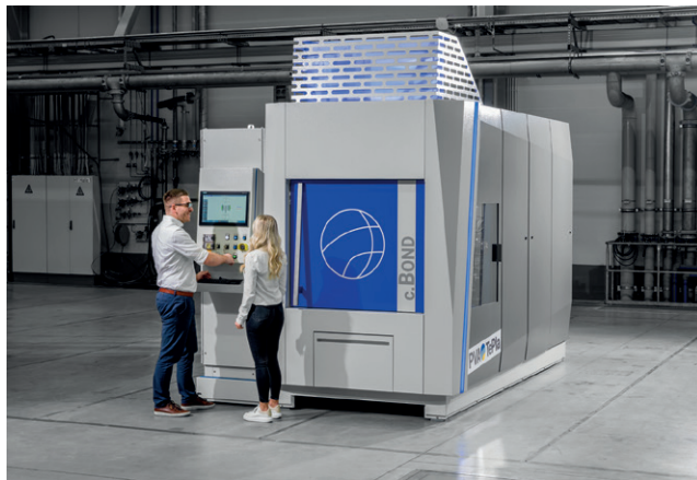
已经开发出一种新的扩散粘接专利方法，能够显著改善速度和工艺控制，尤其适用于铝质组件。该技术通过使用先进的软件和反馈传感器，确保了粘接的精确性和一致性。
